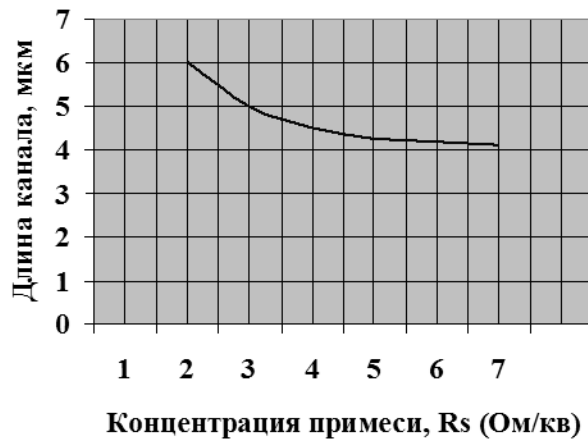
Рис. 3. Зависимость длины канала (толщины обедненной области) от концентрации примеси p^+ -области затвора ( R_s )
